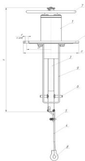
1 - корпус, 2 - фланец, 3 - винт ходовой, 4 - канат, 5 - зажим, 6 - штифт направляющий, 7 - штурвал, 8 - коуш, 9 - направляющая планка
